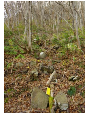
写真9:ブロック4の頂部付近には、上部から下部にかけて堅硬な安山岩溶岩が分布し、ブロックの地すべりを示唆する破碎等は認められない。
