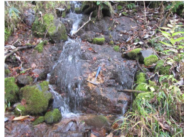
写真14: (写真13の拡大) 堅硬な変質安山岩が連続して分布する。
