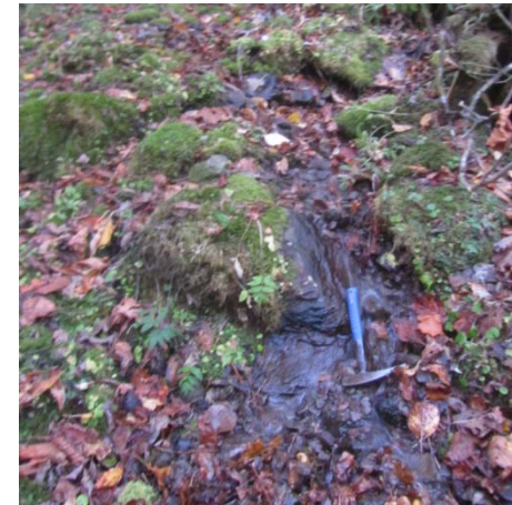
写真10: 写真9の上流の溪床にも堅硬な自破碎溶岩が分布する。
