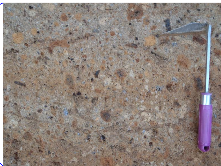
④(クサリ礫化した円-亜角礫を含む砂状主体の粗粒な堆積物)
