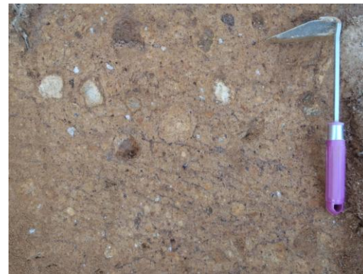
②(風化, クサリ礫化した亜円-亜角礫を含む砂質シルト状の細粒な堆積物)
