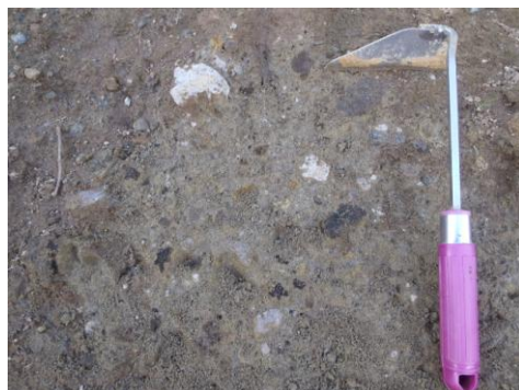
b部拡大 (礫は円磨され、クサリ礫化している。 基質はシルト質砂状の火山灰)
