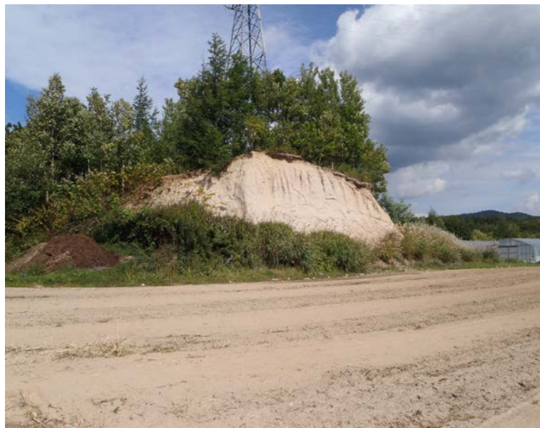
露頭全景 堆積物の層厚は約8mを確認(堆積物頂部の標高は40m程度)
