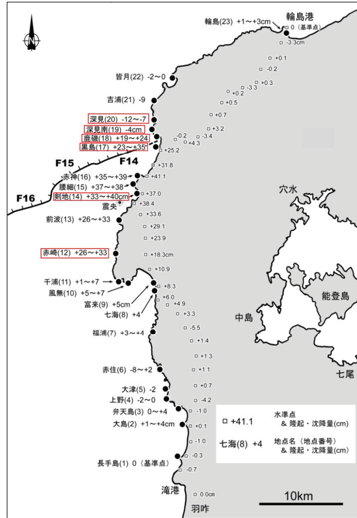
生物指標による隆起・沈降量の測定地点と変動量, および国土地理院が地震後行った水準測量結果 (山本ほか, 2002に加筆)
