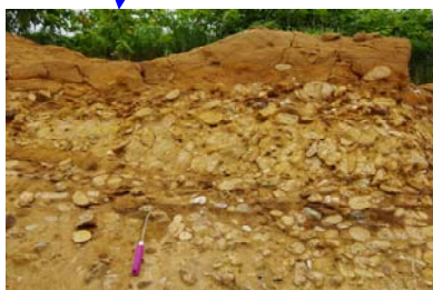
(クサリ礫化した円礫主体の砂礫層)
