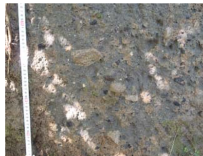
b部 (円磨された未風化の軽石を主体とする。 基質は粗粒砂状の火山灰で、締まっている。)
