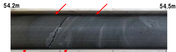
①深度54.2~54.5m 傾斜約30° の成層構造が認められる
