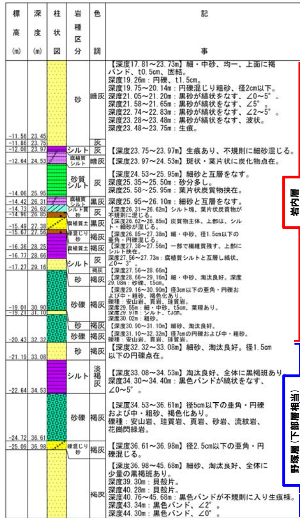
ボーリング柱状図 (深度20~40m)
