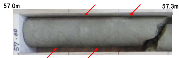
②深度57.0~57.3m 傾斜約35° の成層構造が認められる
