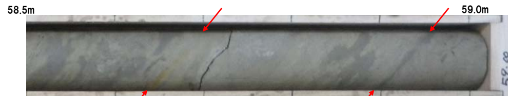
③深度58.5~59.0m 傾斜約45° の成層構造が認められる
