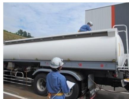
③タンクローリー上部の蓋開放 (タンク内の負圧防止措置)
