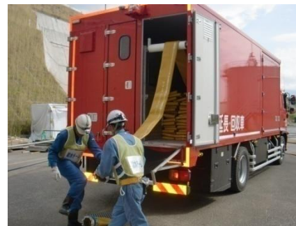
ホース延長・回収車からの手動によるホースの引出作業
