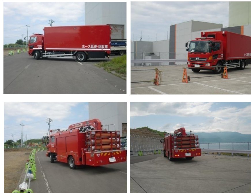
Step No. 10-b-2 可搬型大型送水ポンプ車/ホース延長・回収車で T.P.31m法面への移動
