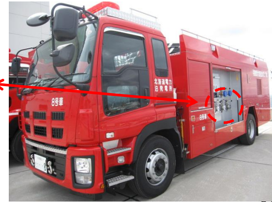
【可搬型大型送水ポンプ車の吸込み部(水中ポンプからのホース接続部)】
