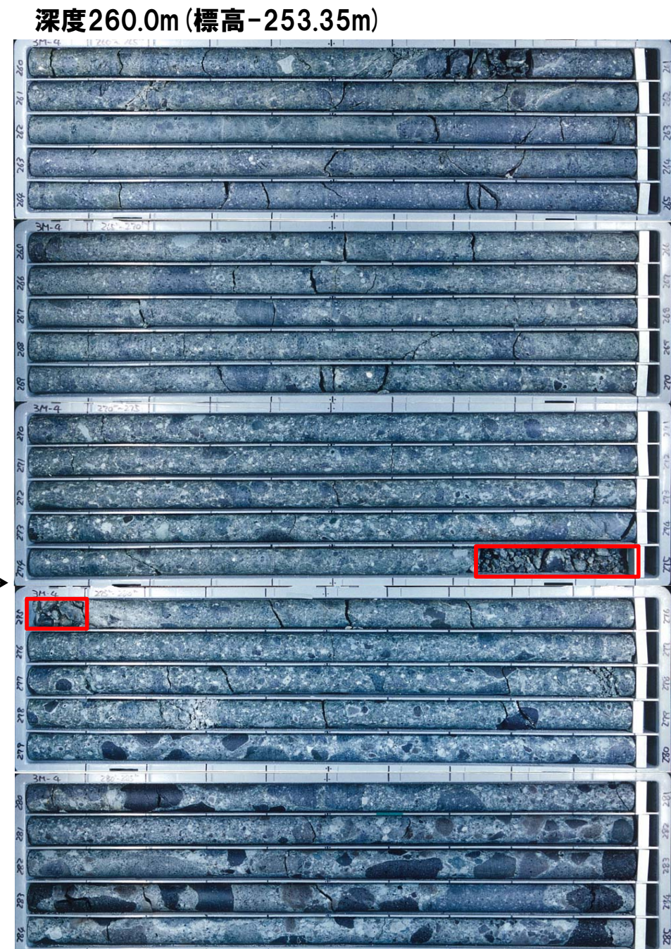
深度260.0m (標高-253.35m) 深度285.0m (標高-278.35m) :破砕部 (深度274.74-275.10m) ボーリングコア写真 (3M-4孔)
