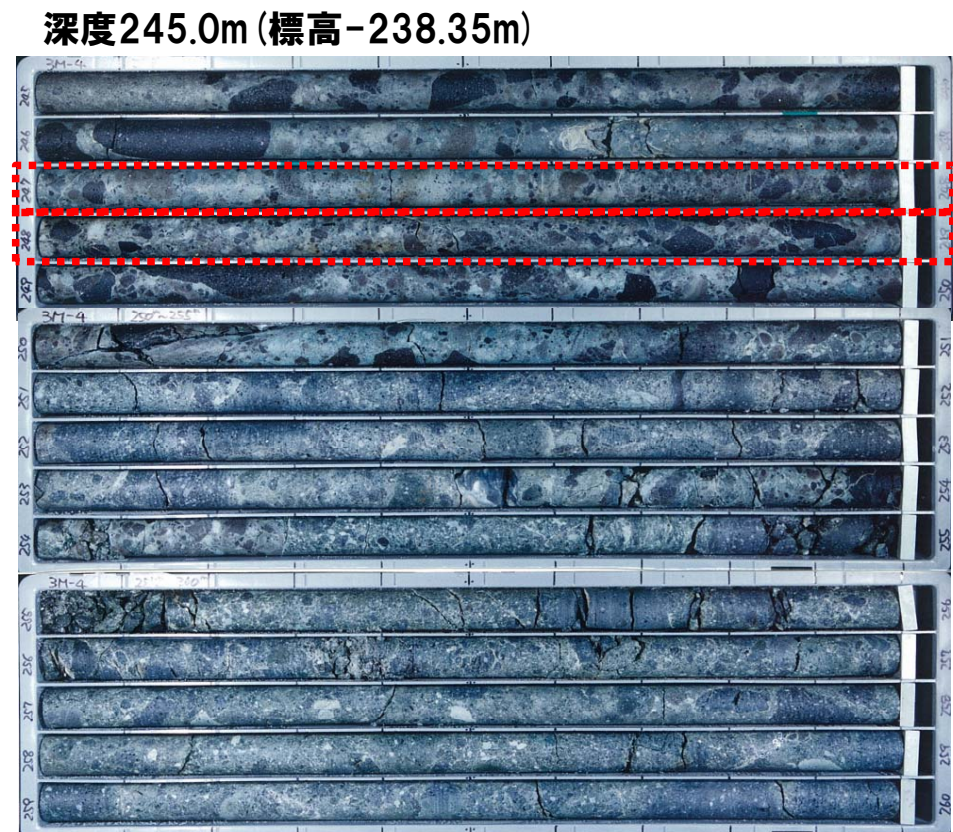
深度245.0m (標高-238.35m) 深度260.0m (標高-253.35m) :F-7断層推定延長位置 (深度247-249m付近) ボーリングコア写真 (3M-4孔)
