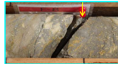
条線確認箇所拡大 (深度149.15~149.23m)
