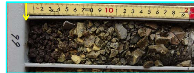
条線確認箇所拡大 (深度66.00~66.20m)
