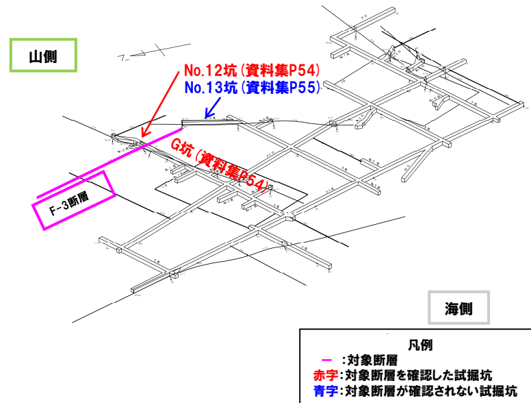
試掘坑におけるF-3断層の確認位置
