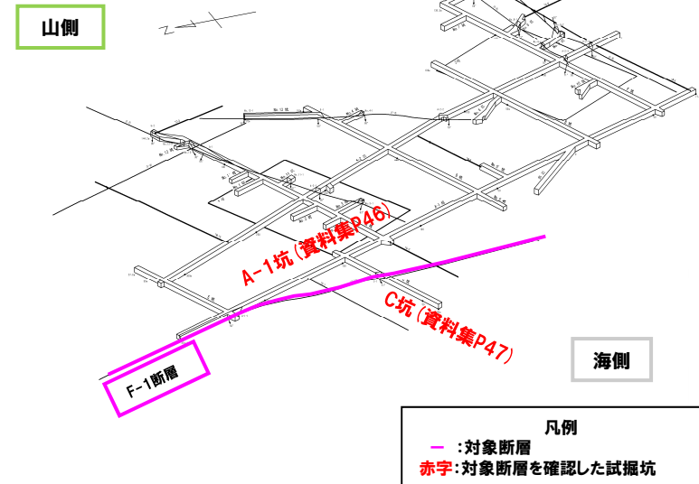
試掘坑におけるF-1断層の確認位置
