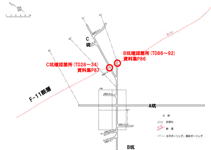
3号炉試掘坑におけるF-11断層確認位置 (※断層位置はEL.2.8mで記載)
