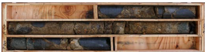
コア写真(照岸1-5別孔 深度5.5m~7.5m)
