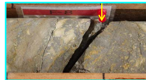
条線確認箇所拡大 (深度149.15~149.23m)
