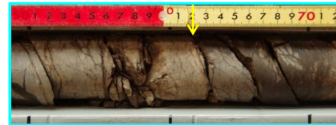
条線確認箇所拡大 (深度29.50~29.70m)
