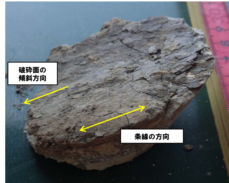
破砕面(下盤側)の状況
