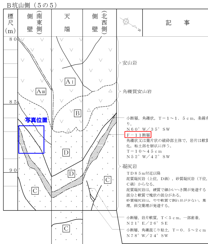
試掘坑展開図 (B坑)
