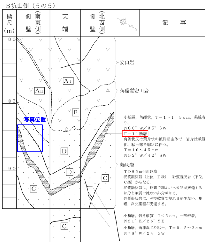
試掘坑展開図 (B坑)
