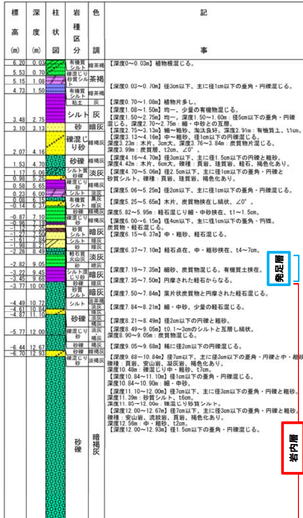
ボーリング柱状図 (深度0~20m)
