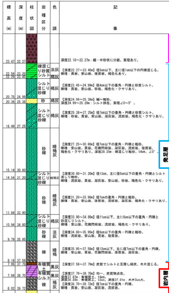
ボーリング柱状図 (深度20~40m)
