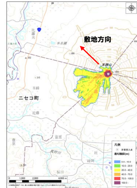
羊蹄山における 溶岩流シミュレーション結果(溶岩流最大流動深)
