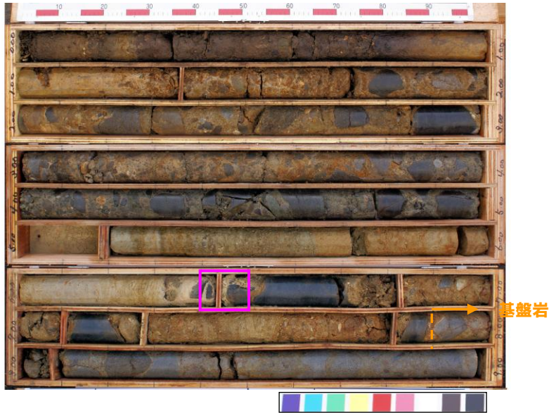
□ : 洞爺火山灰確認位置 (6.4~6.5m) EL19.4~19.3m コア写真(照岸1-3)
