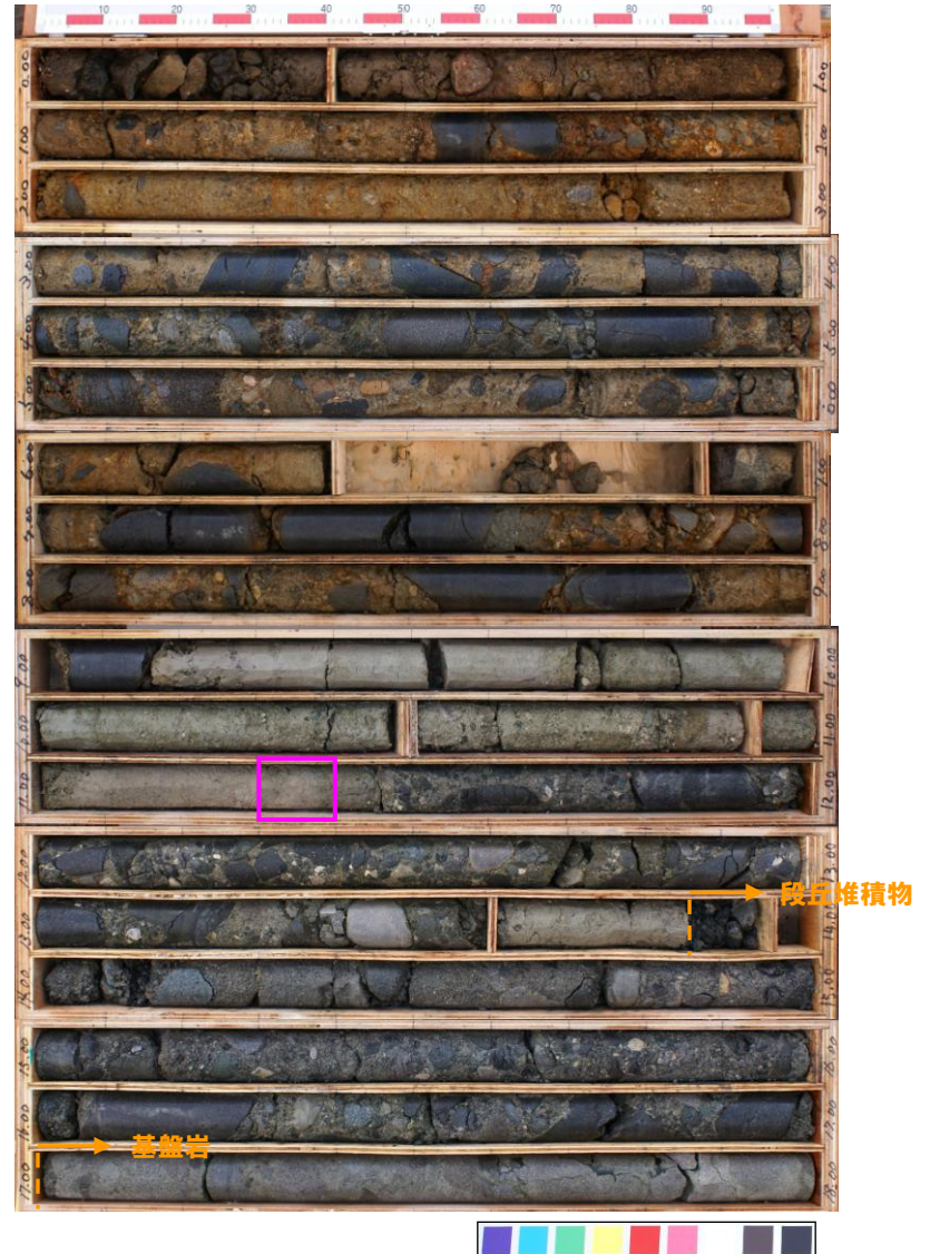
□ : 洞爺火山灰確認位置 (11.3~11.4m) EL26.8~26.7m コア写真(照岸1-5)
