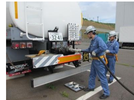
②タンクローリーへ 給油ホースの接続
