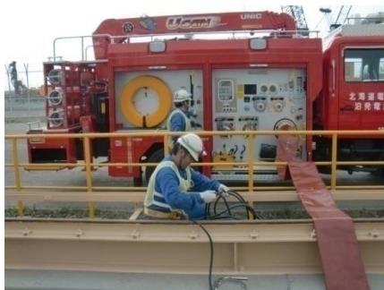
水中ポンプと可搬型大型 送水ポンプ車入口とのホース 接続作業
