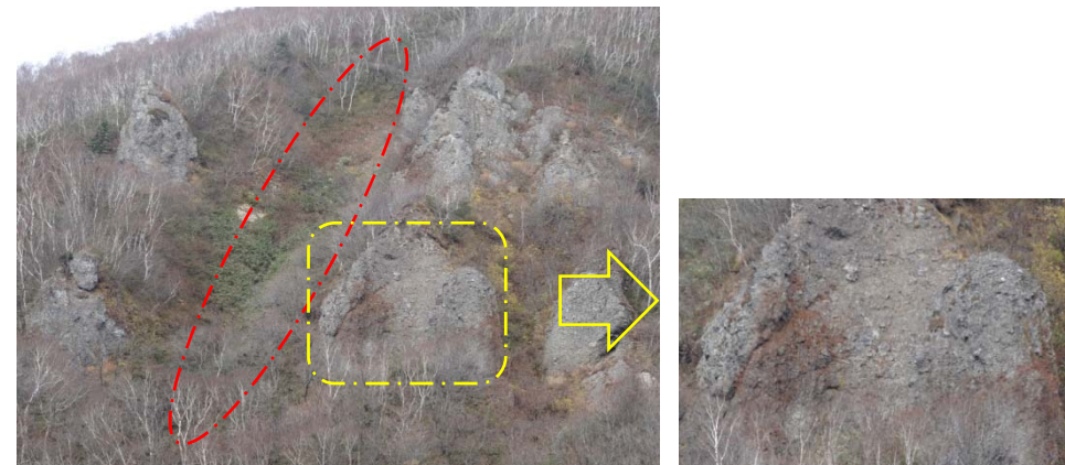
写真4: (写真3の拡大) 塊状溶岩類の露頭は、凹凸に富み、肌落ちやブロックの抜けが認められる。露頭間は開析された沢地形を呈する。
