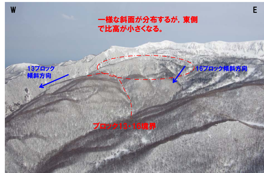
写真3: ブロック13・16境界（地すべり地形DBブロック9・11） 地すべり地形DBの滑落崖位置には斜面が認められることから、樹枝状を呈する沢から尾根の鞍部を境界とした。
