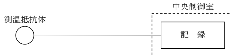
第2図 使用済燃料ピット温度 (AM用) の概略構成図
