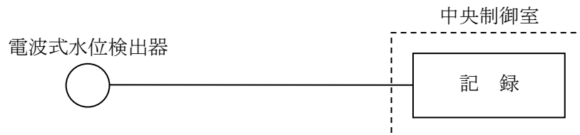
第1図 使用済燃料ピット水位 (AM用) の概略構成図
