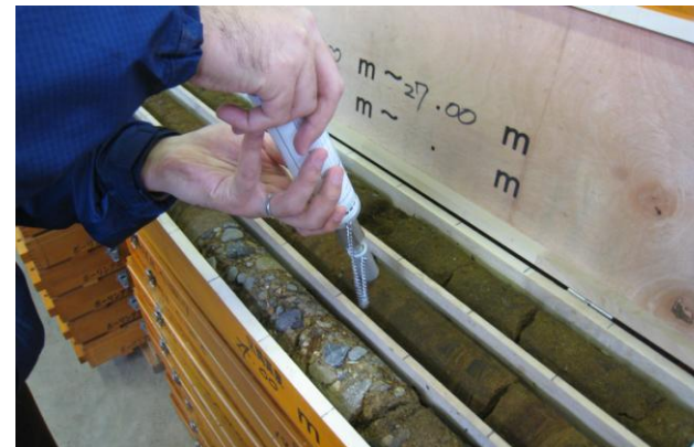
針貫入試験実施状況
