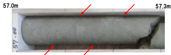
②深度57.0~57.3m 傾斜約35°の成層構造が認められる
