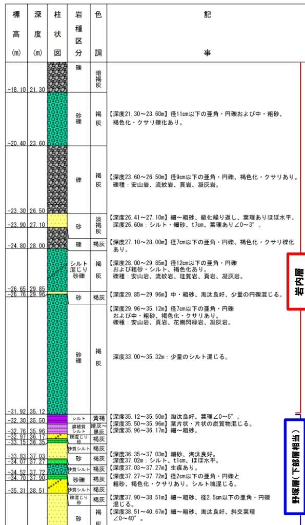
ボーリング柱状図(深度20~40m)
