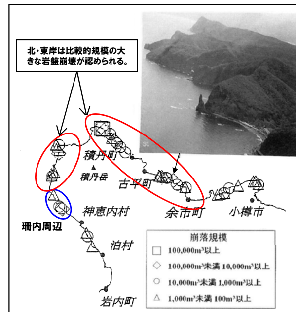
積丹半島付近における岩盤崩壊分布図 (米田ほか, 2002に一部加筆)
