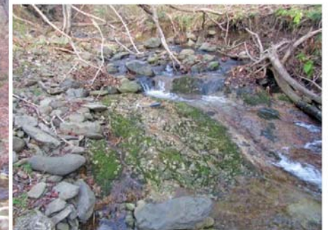
写真11:地すべりブロック東側の沢の河食崖に分布する自破碎溶岩。付近の河床でも確認される。
