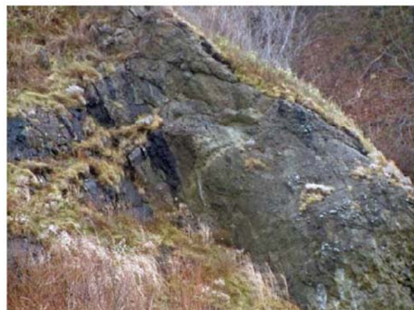
写真5:(写真4の拡大)自破碎溶岩の状況, 滑落崖等は認められない。
