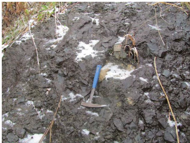
C04:C03の神恵内層の自破碎溶岩。
