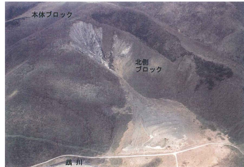
写真2: むかわ町八幡地区の地すべり 滑落崖の平面形が馬蹄形を示す。 北海道地すべり学会 (2012) より
