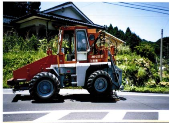
震源車(油圧インパクト) 全幅: 1.9m 全長: 4.8m 全高: 2.8m 重量: 6.0t
