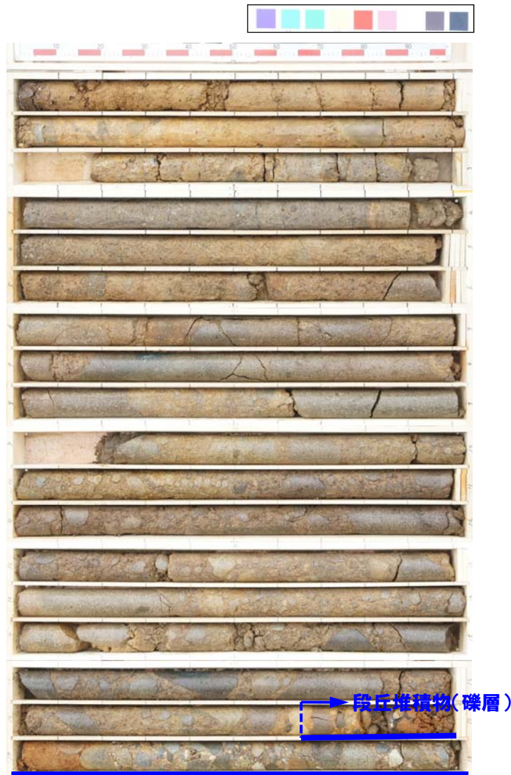
深度16.65m以深に段丘堆積物を確認した。 段丘堆積物: 亜円礫を主体とする。基質は中粒～粗粒砂からなる。 コア写真(古平川M-2:深度0～18m)
