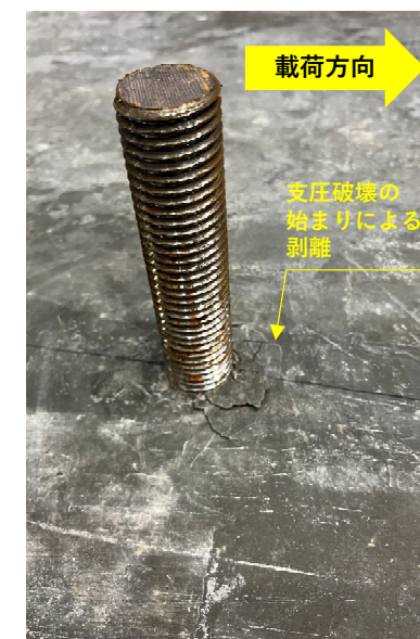
せん断試験後の状況写真
