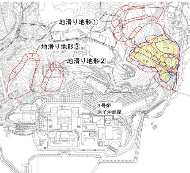
発電所背後の斜面に見られる地滑り地形位置図 「第6条：外部からの衝撃による損傷の防止(外部事象の考慮について)」(一部修正)
