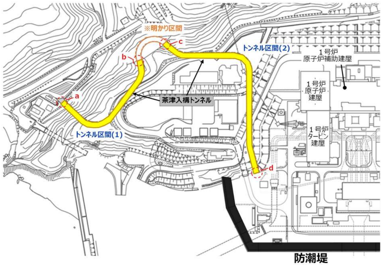
【茶津入構トンネル 平面図】
