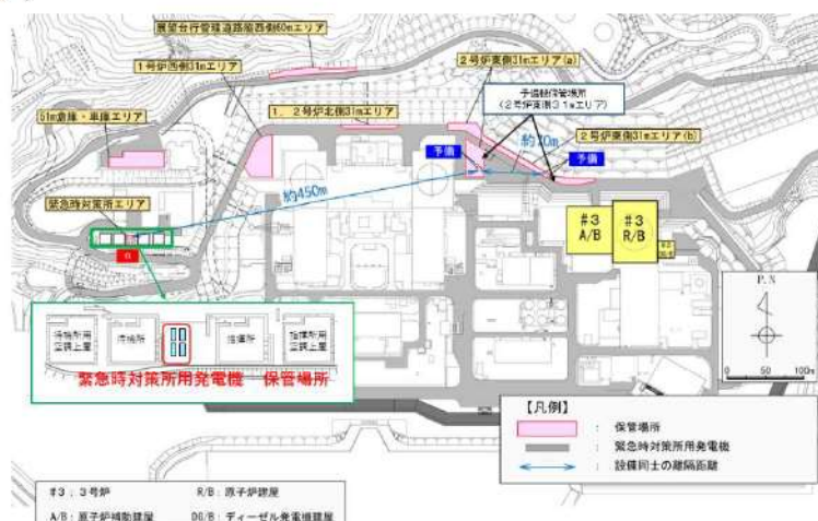
図4-10 緊急時対策所用発電機の保管場所
