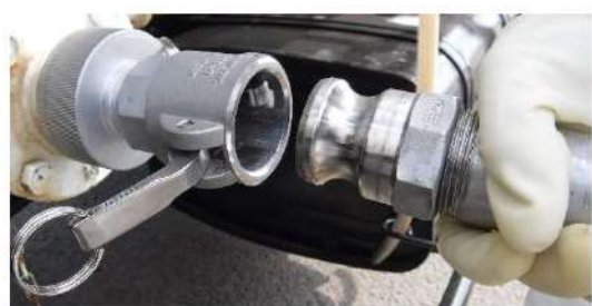
可搬型タンクローリーへのホース接続(継手接続式) (屋外)
