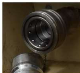
可搬型代替電源車の給油口へのホース接続（クイックカップラ式） （可搬型代替電源車） （屋外）
