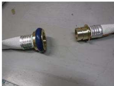
消防ホース (40 A) 接続前
