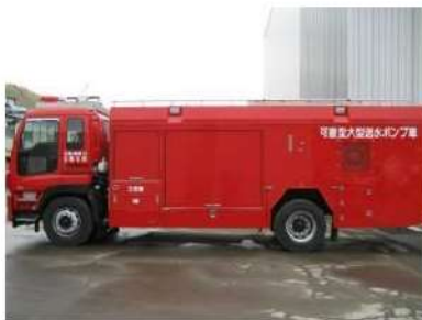
可搬型大型送水ポンプ車
