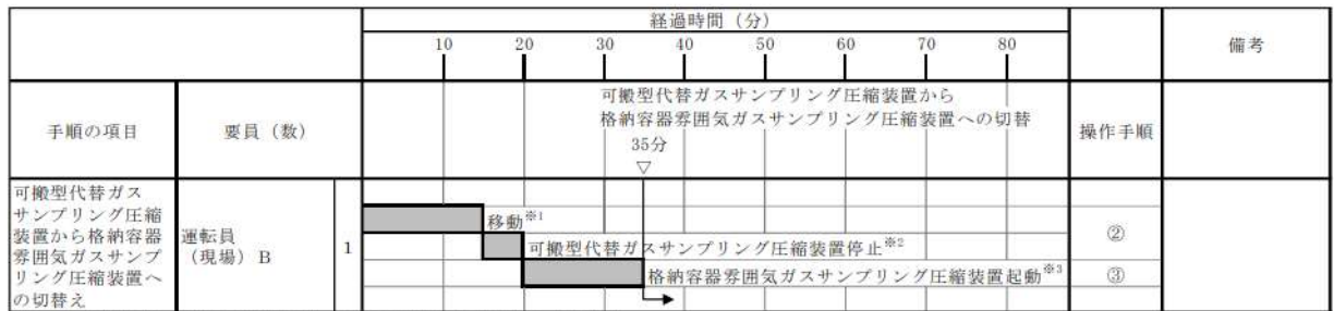
第 1.9.11 図 ガス分析計による原子炉格納容器内の水素濃度監視 タイムチャート
