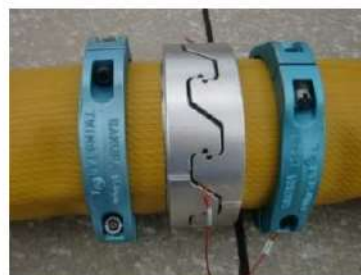
可搬型ホース(150A)接続後
