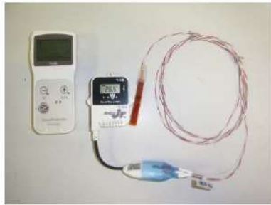
可搬型温度計測装置（格納容器再循環ユニット 入口温度／出口温度） （左：データコレクタ，右：温度ロガー）
