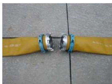
可搬型ホース(150A)接続前
