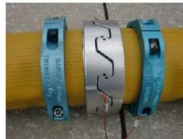
可搬型ホース(150A)接続後
