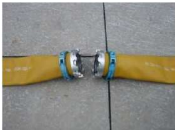
可搬型ホース (150A) 接続前
