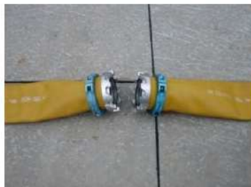
可搬型ホース（150A）接続前
