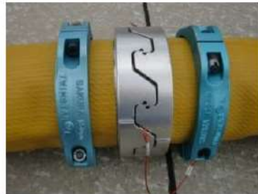
可搬型ホース（150A）接続後
