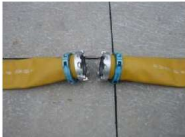
可搬型ホース (150A) 接続前
