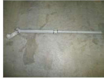
専用工具（蒸気加減弁開操作用） （タービン動補助給水ポンプ室に保管）
