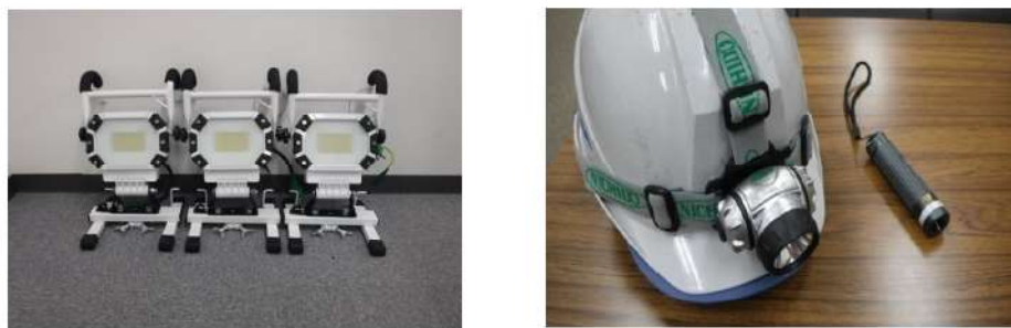
図 18 可搬型照明（SA）、可搬型照明（ヘッドライト）等
