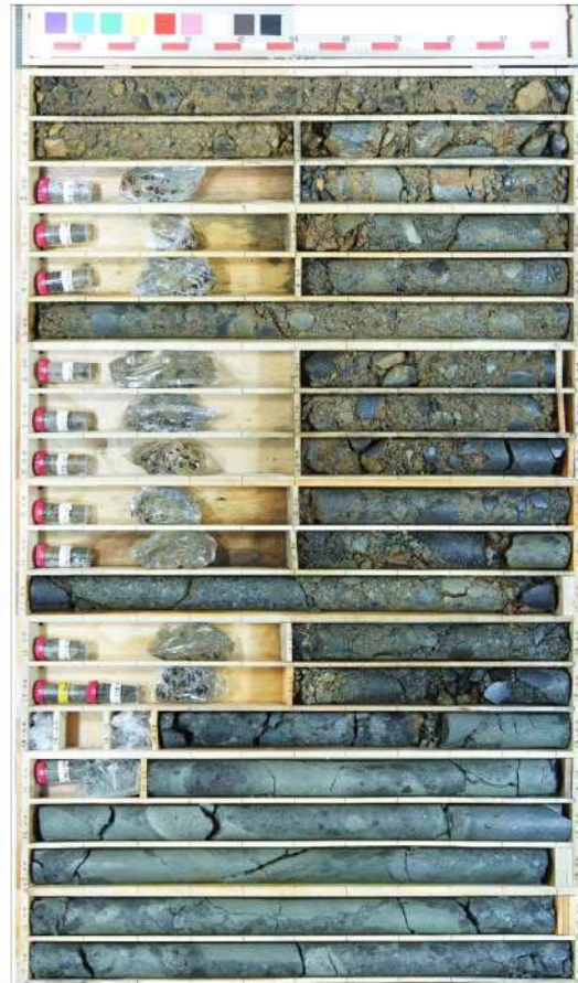
添付 1-1 図 ボーリング柱状図・コア写真 (SW2-3)
