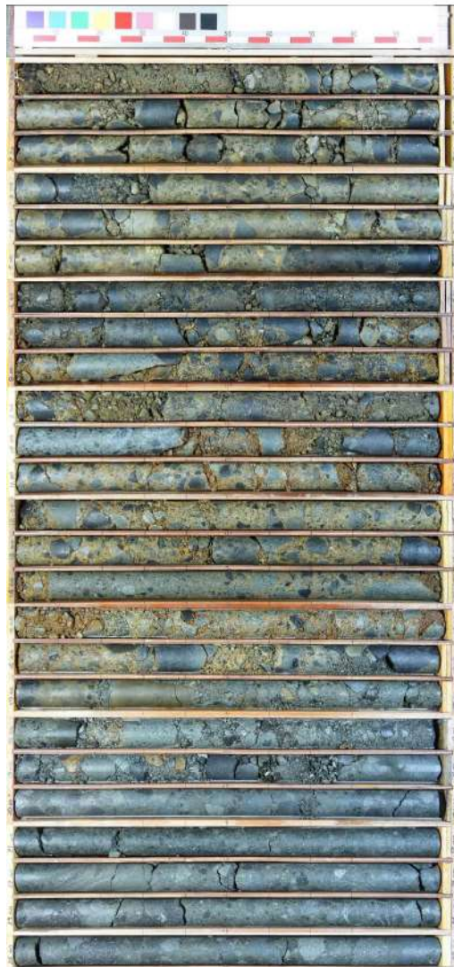
添付 1-4 図 ボーリング柱状図・コア写真 (RE-1)
