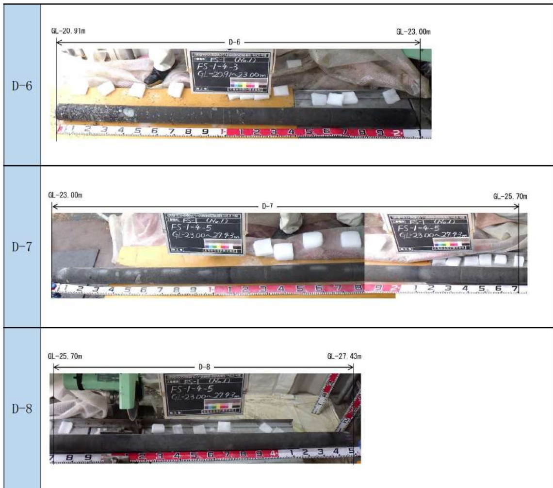
添付 1-24 図(10/10) ボーリング柱状図・コア写真 (FS-1)
