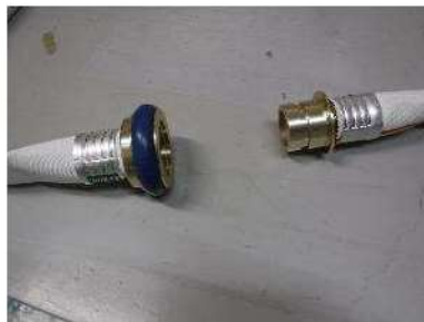
消防ホース (40 A) 接続前
