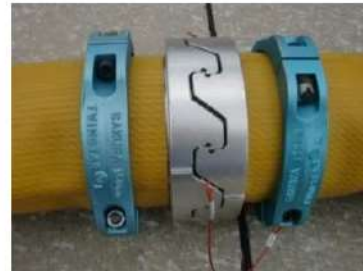
可搬型ホース（150A）接続後
