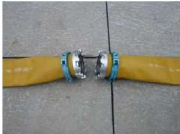
可搬型ホース（150A）接続前
