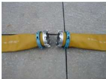
可搬型ホース（150A）接続前
