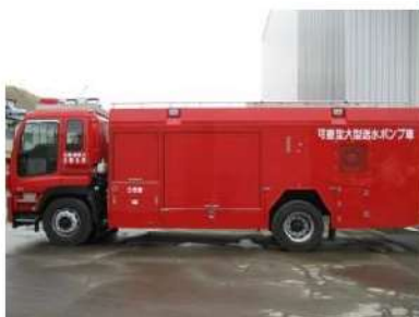
可搬型大型送水ポンプ車
