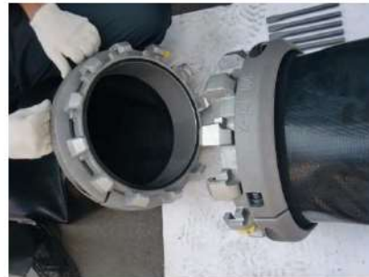
可搬型ホース (300A) 接続
