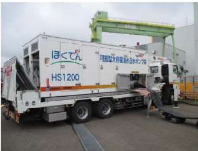
可搬型大容量海水送水ポンプ車の設置 (屋外 T. P. 10. 3m)
