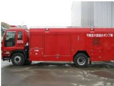
可搬型大型送水ポンプ車
