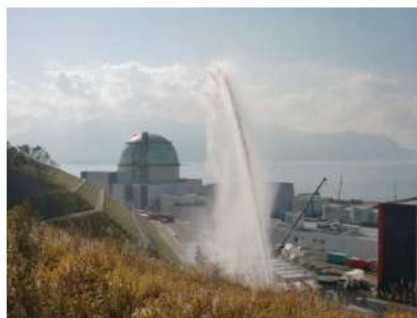
第2図 直線状放射による放水状況
