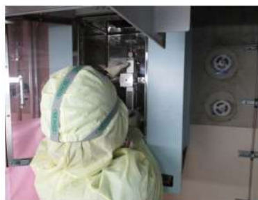
試料採取管によるガス採取 (原子炉建屋 T. P. 28.0m)
