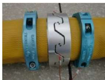
可搬型ホース(150A)接続後
