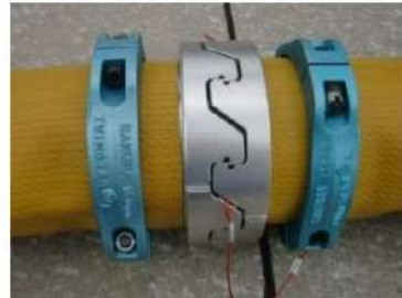
可搬型ホース (150A) 接続後
