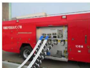
可搬型大型送水ポンプ車 周辺のホース敷設 （屋外 T. P. 33. 1m）
