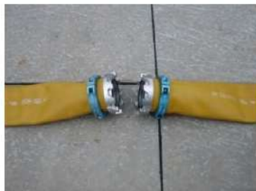
可搬型ホース（150A）接続前
