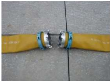
可搬型ホース (150A) 接続前
