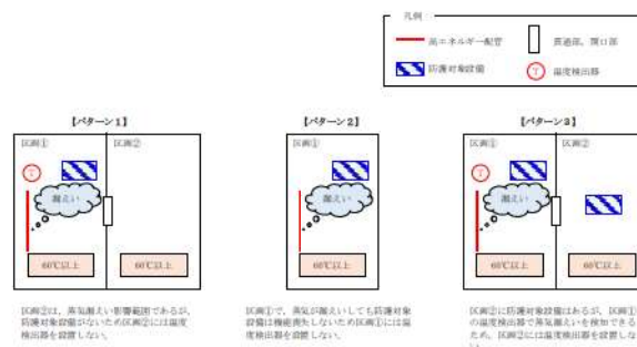
図2 区画配置温度検出器設置概念図
