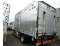
大規模損壊対応用変圧器車
