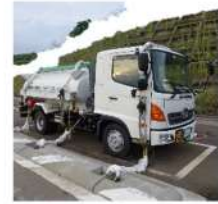
可搬型タンクローリー
